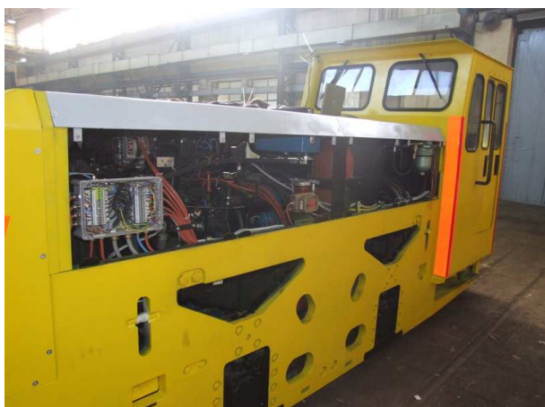
Rys. 11. Lokomotywa WLP-50EM napędzana silnikiem 4CT107 [11]
