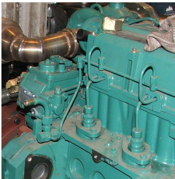
Rys. 5. Układ UPS – pompa-przewód-wtryskiwacz [11]
