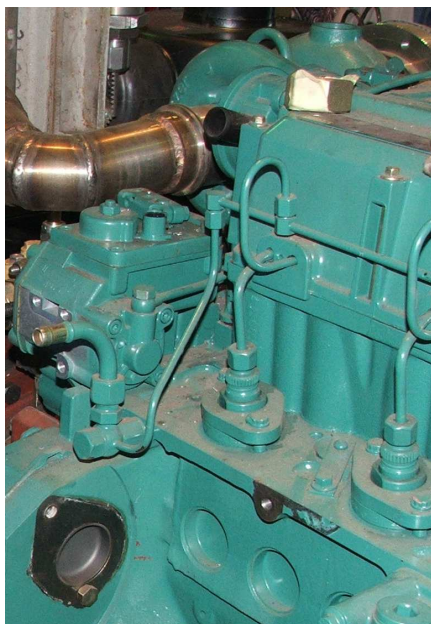
Rys. 14. Silnik Deutz D5A T (widok pomp jednosekcyjnych i przewodów wysokociśnieniowych) [11]
